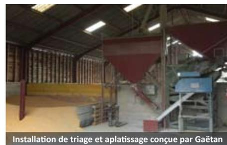
Installation de triage et aplatissage conçue par Gaëtan
